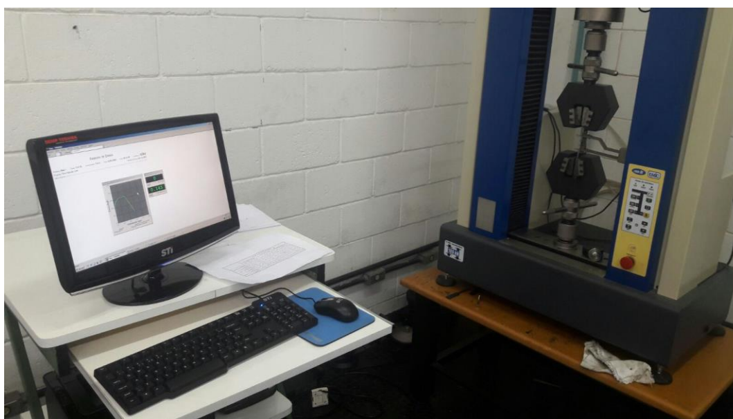
Figura 107 – Conjunto para ensaio efetuando a curva no momento da tração.
