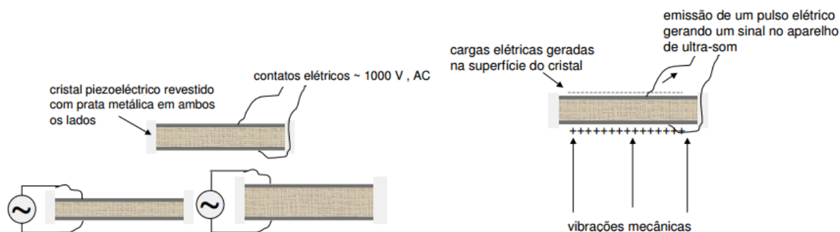
Figura 67 – Contração e expansão do cristal quando submetido a uma alta tensão alternada na mesma frequência ultrassônica emitida pelo cristal. É um processo de transformação da energia elétrica em energia mecânica e vice-versa (ANDREUCCI, 2014).
