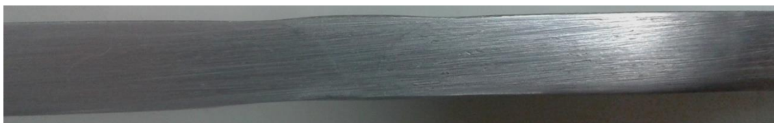
Figura 105 – Aspecto do cordão de solda do corpo de prova soldado pelo processo FCAW.
