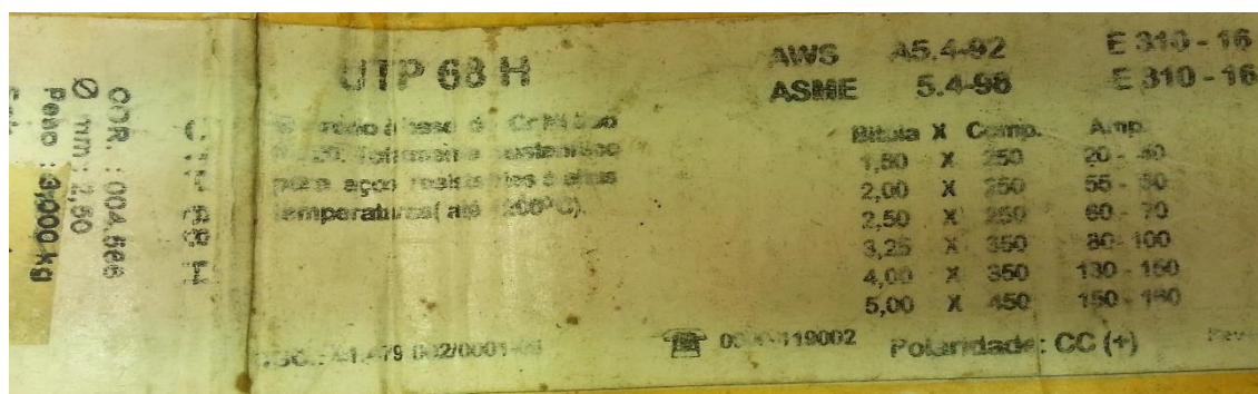
Figura 94 – Consumível E310-16, com diâmetro de 2,5mm e comprimento de 250mm, com classificação AWS A5.4-92, do fabricante Böhler Welding .
