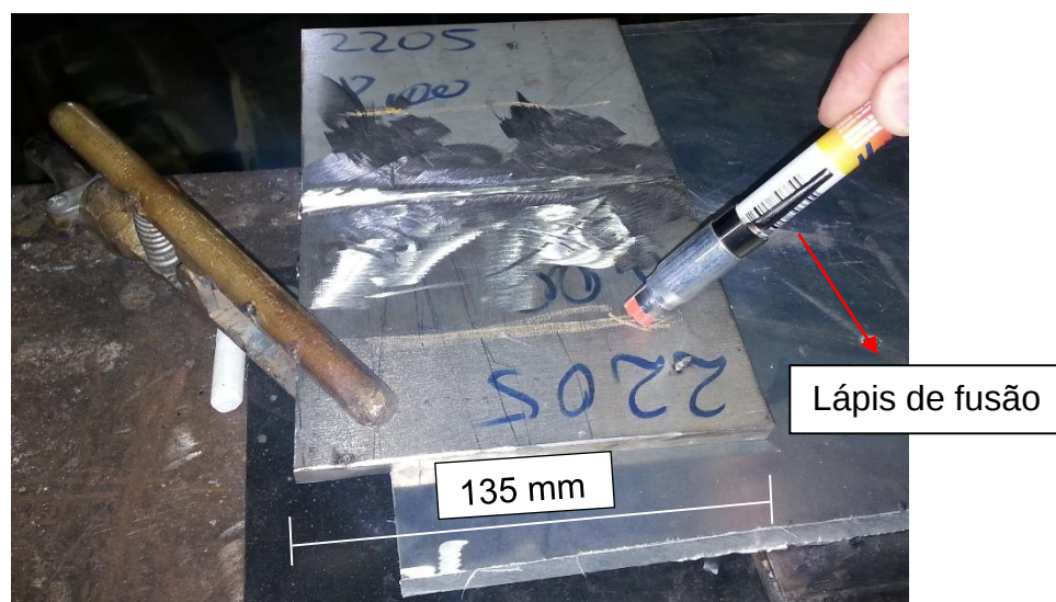
Figura 87 – Utilização do lápis de fusão para verificação da temperatura
