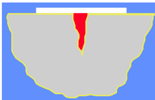
Figura 71 – Aplicação do revelador e observação da indicação (ANDREUCCI, 2014).
