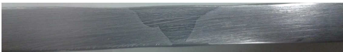
Figura 104 – Aspecto do cordão de solda do corpo de prova soldado pelo processo SMAW.
