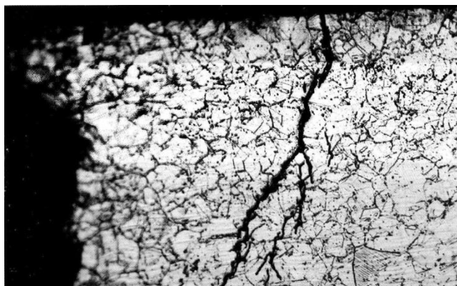
Figura 8 – Fotomicrografia de uma trinca de corrosão sobtensão (CALLISTER, 2008).
