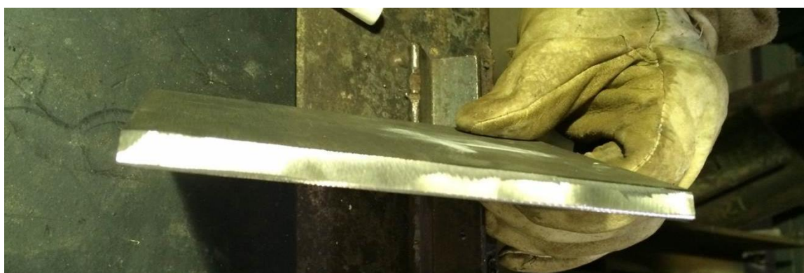
Figura 84 – Peça chanfrada por esmerilhamento.
