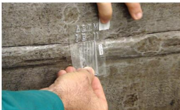
Figura 77 – Posicionamento de IQI tipo fio (ANDREUCCI, 2014).
