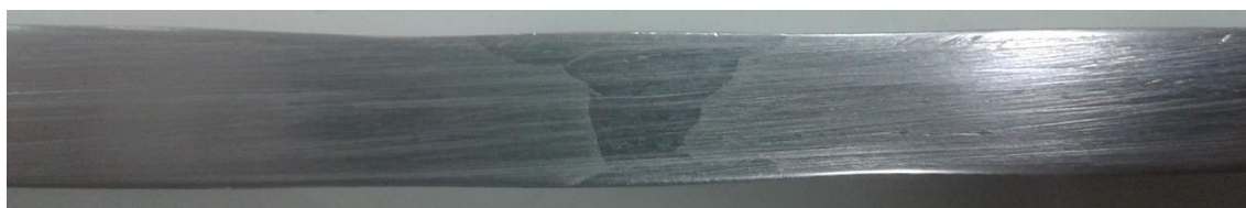
Figura 103 – Aspecto do cordão de solda do corpo de prova soldado pelo processo GTAW.
