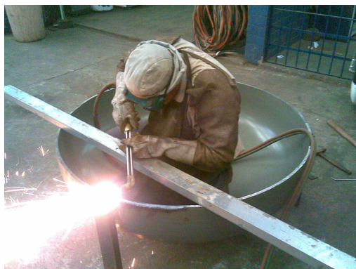
Figura 23 - Corte na calota
