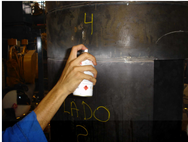
Figura 28 – Aplicação do “Revelador”.
