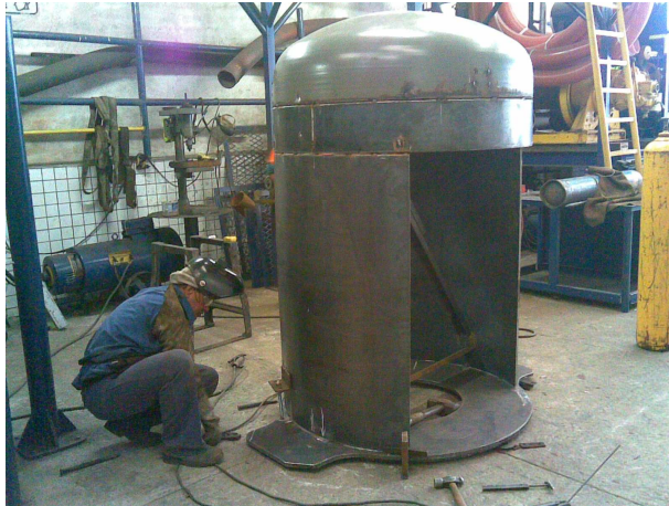
Figura 26 – Fixação do conjunto ao Piso
