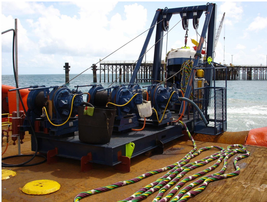
Figura 18 - Sistema de Elevação de Carga
