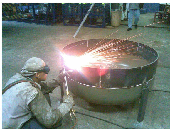
Figura 24 – Corte do Anel da Calota
