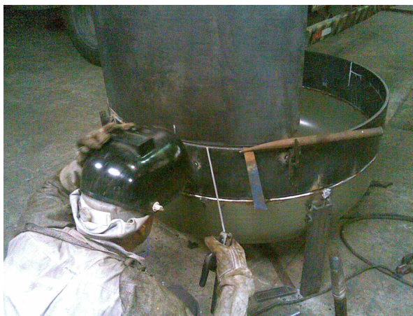
Figura 25 – Ponteamento das Laterais Calandradas
