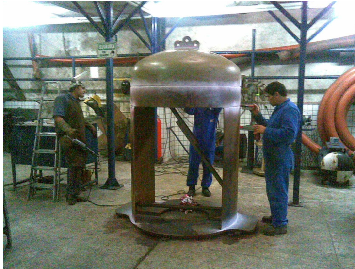
Figura 30 - Sinete aprovado no teste de solda.
