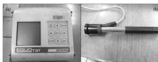
Figura 7 – Aparelho medidor de dureza (a) e transdutor de impacto (b).
