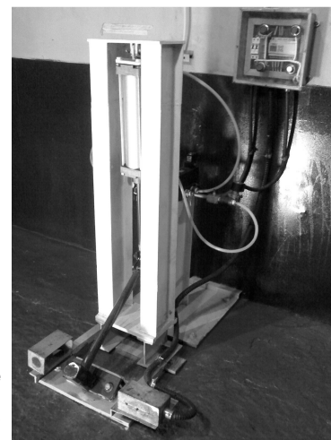
Figura 16 – Fase de acabamento da máquina de ensaio de Impacto.
