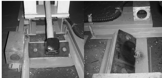
Figura 14 – Etapa de fixação da base de impacto e ajustagem do sensor óptico.
