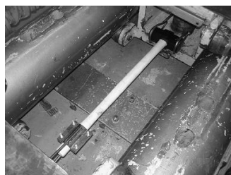
Figura 10 – Etapa de fixação da marreta antes do ensaio de tração.
