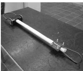
Figura 9 – Dispositivos para fixação da marreta na máquina de ensaio de tração.
