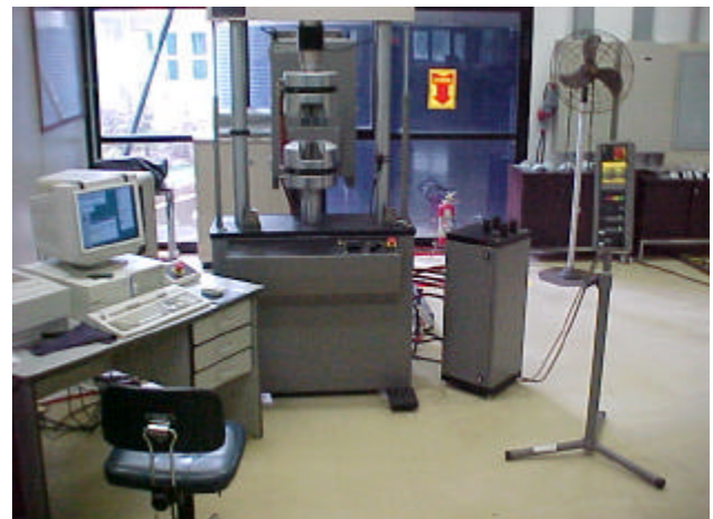
Figura I.16 – Exemplos de máquinas de tração eletromecânica (à esquerda) e servo-hidráulica (à direita), ambos os equipamentos foram fabricadas pela MTS.
