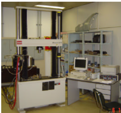
Figura I.16 – Exemplos de máquinas de tração eletromecânica (à esquerda) e servo-hidráulica (à direita), ambos os equipamentos foram fabricadas pela MTS.
