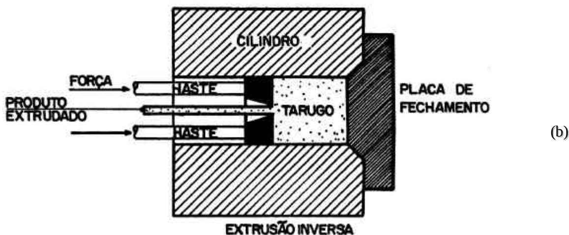
Figura 3.5 – Esquema de funcionamento do processo de extrusão, Helman e Cetlin, 1983.
