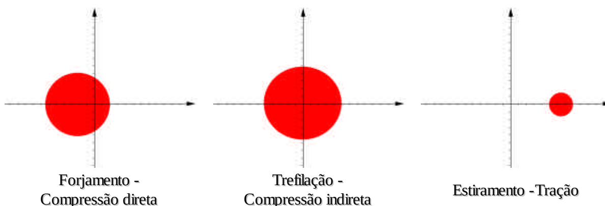
Figura 3.2 – Exemplos de três situações de carregamento mecânico em conformação mecânica segundo descrito pelos círculos de Mohr nas regiões de conformação mecânica, Willy Ank.
