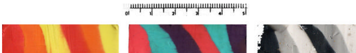
Figura 2.19 – Diferentes perfis de deformação com o emprego de uma matriz de extrusão com muito lubrificante (esquerda), média quantidade (centro) e pouco (direita).
