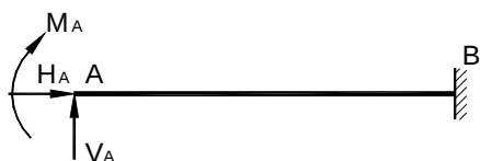
figura 10 – Barra isostática com as reações em A
