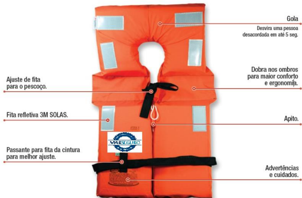
Figura 14 – Colete salva-vidas Classe II SOLAS, tipo canga.
