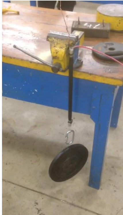
Figura 28 - Músculo Comprimido com Carga de 10 kg (Fonte: Autoria Própria, 2018)
