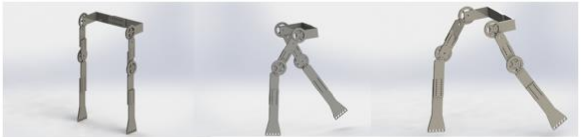
Figura 22 - Simulação da Marcha Realizada pelo Protótipo (Fonte: Autoria Própria, 2018)
