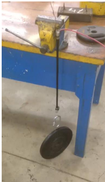
Figura 27 - Músculo Tracionado com Carga de 10 kg (Fonte: Autoria Própria, 2018)
