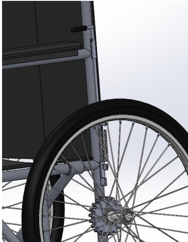
Figura 24 - Cadeira de rodas com dispositivo contra recuo.
