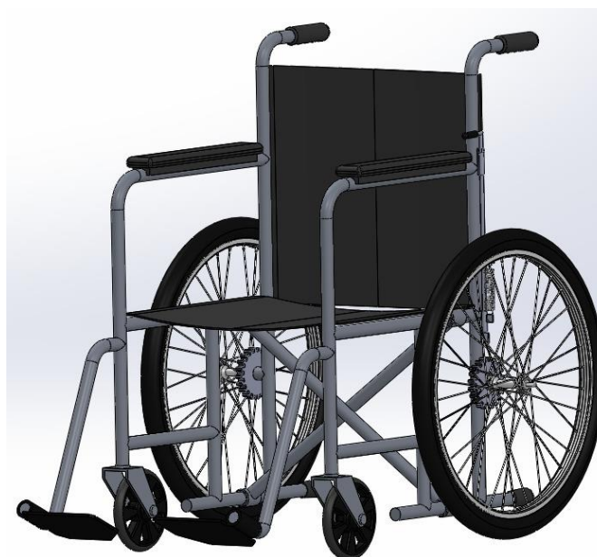
Figura 22 - Cadeira de rodas com dispositivo contra recuo.
