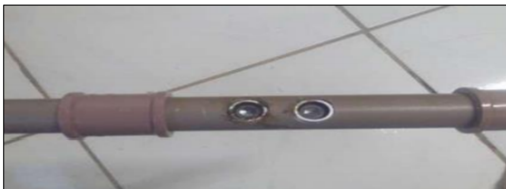
Figura 2 - Estrutura física da bengala com sensor
