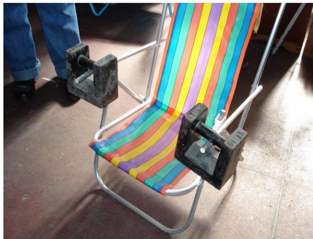
Figura 4 – Ensaio com a cadeira de praia Fonte: Inmetro, 2015
