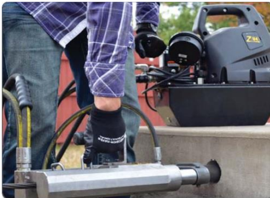
Figura 6: macaco hidráulico de protensão
