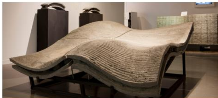
Figura 18 - Experiência construída através da Concrete Priting
