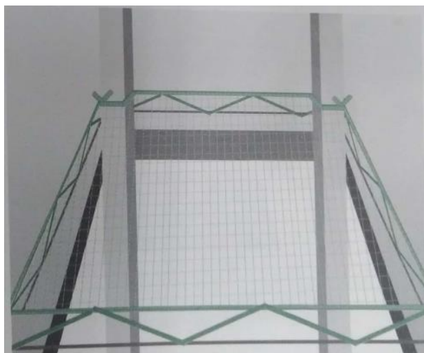
Figura 59 – Fechamento de armadura do piso com rede e cordas
