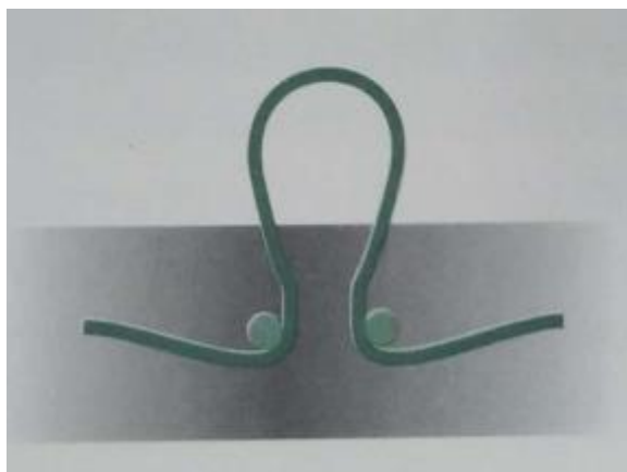
Figura 25 – Ancoragem com perfuração do concreto
