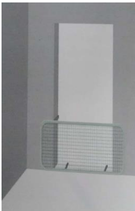
Figura 73 – Proteção de vão de acesso a elevador com estrutura metálica e tela
