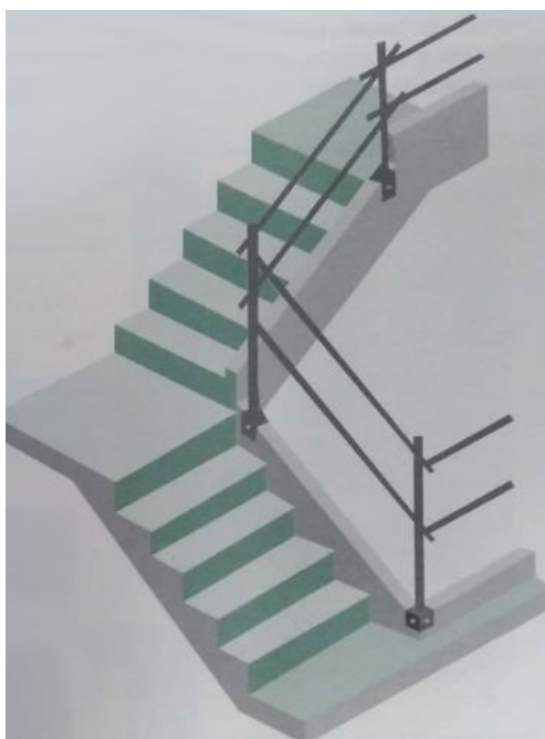
Figura 62 – Proteção provisória de escada interna com guarda-corpo de estrutura metálica
