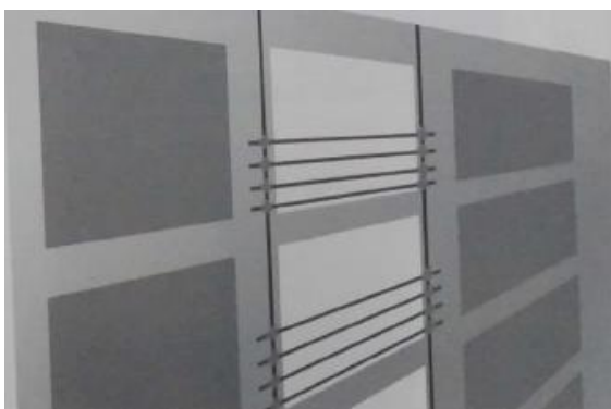
Figura 77 – Fechamento da periferia com estrutura metálica
