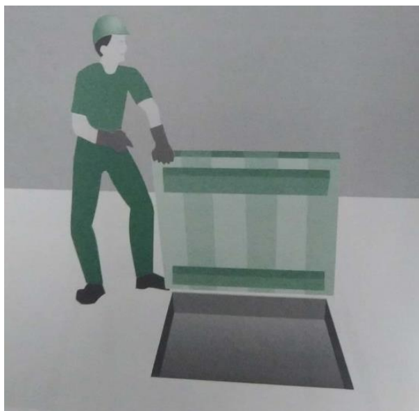
Figura 61 – Fechamento removível de abertura no piso com madeira suportada por travessas de madeira
