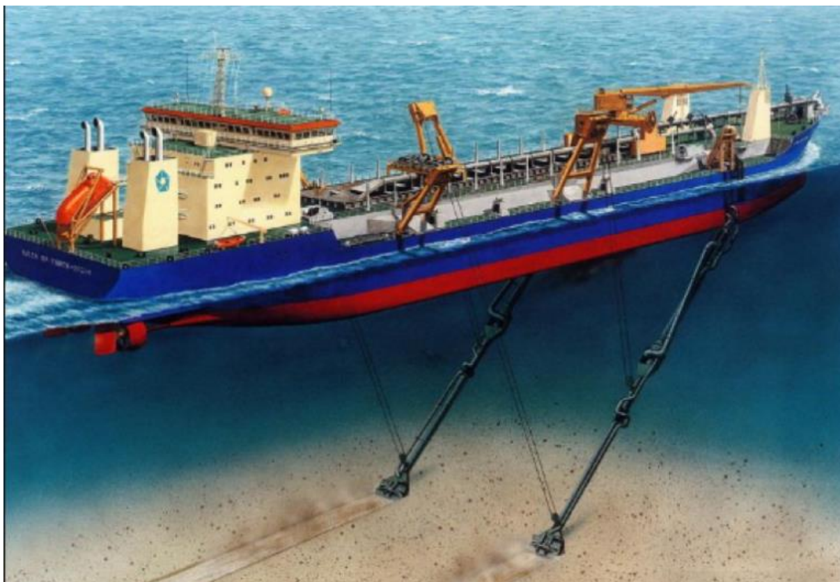
Figura 05 - Ilustração de uma draga trailing hopper dredge .
