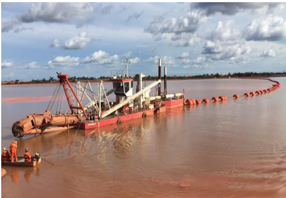
Figura 03 - Ilustração da cutterhead suction dredge
