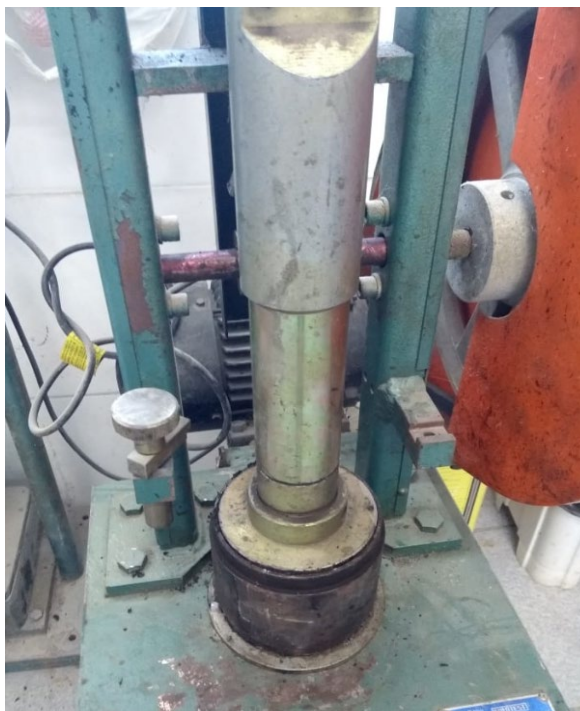
Figura 18 Moldagem do corpo de prova
