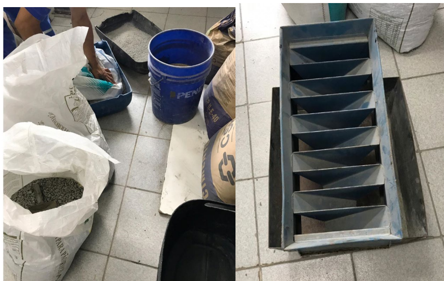
Figura 9 Processo para ser quarteado
