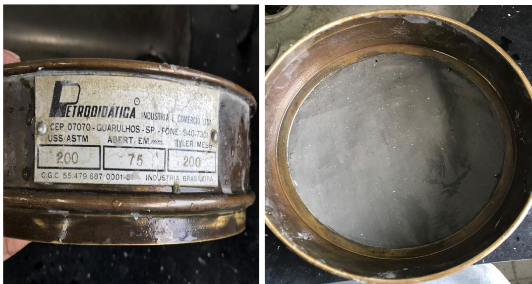
Figura 10 Modelos de peneiras utilizadas
