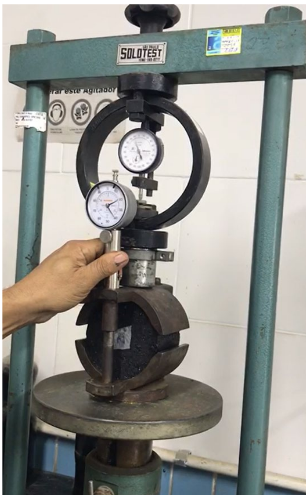
Figura 23 Leitura da estabilidade Marshall
