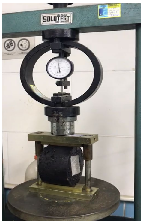
Figura 27 Ensaio de resistência a tração por compressão diametral
