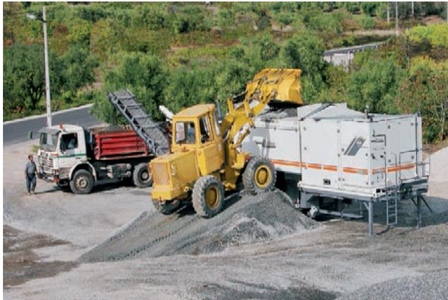
Figura 15 operação usina de reciclagem a frio. Fonte: Wirtgen (2016)
