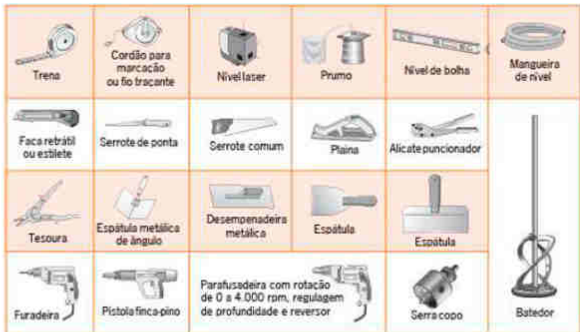
Figura 6 - Tipos de ferramentas para execução de paredes em gesso acartonado (Associação Brasileira do Drywall, 2016)
