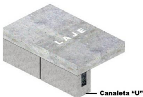
Figura 11: Encontro laje-parede com bloco "U" (Freitas Jr, 2013)
