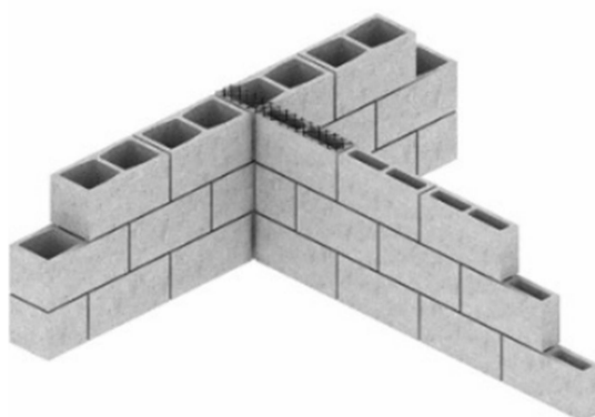
Figura 6: Encontro entre paredes em "T" (Freitas Jr, 2013)
