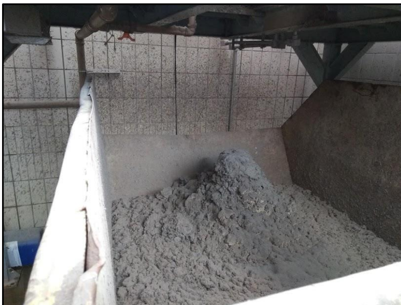
Figura 24 - Depósito do lodo.
