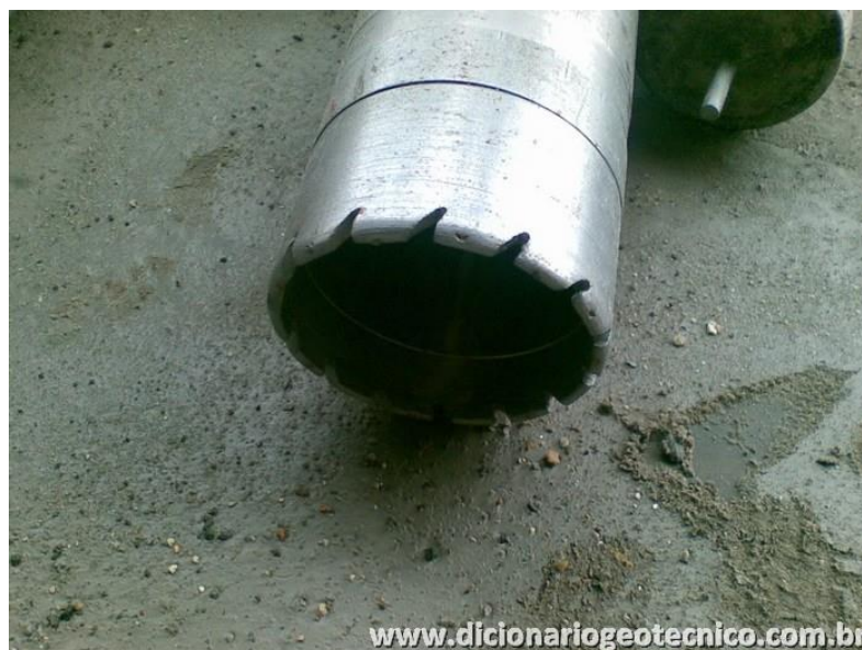
Figura 4: Sapata de perfuração
