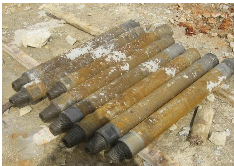
Figura 2: Tubos de revestimento
