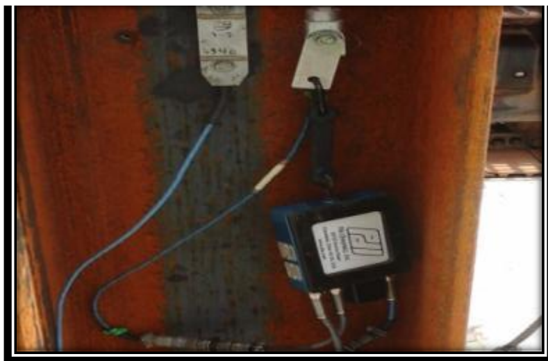
Figura 5 - Ensaio PDA, instalação de sensores, .
